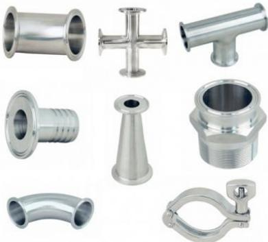
La conexión más usada por su fácil manejo de ensamble y desmontaje en cualquier equipo o instalación, la tenemos disponible en medida desde ½", hasta 8" y en materiales de inoxidable T304 y T316L. Nuestra gama de empaques clamp están disponibles en materiales Buna-N, Epdm, Teflón, Vitón y Silicón.
