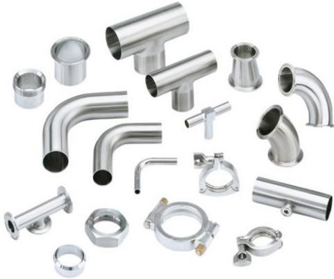
Nuestras conexiones soldables son usadas en instalaciones permanentes donde el proceso con tubería y equipo puede ser limpiado en el lugar (CIP) y no requiere desensamble frecuente. Las conexiones soldables se ofrecen en las medidas nominales de tubería desde ½ hasta 8"Ø en acero inoxidable 304 o 316L. El espesor estándar de ½" hasta 3" Ø es de 0.065 (cal 16), para 4" 0.083 (cal 14), 6" y 8" Ø 0.109 (cal12). Ofrecemos pulido I.D. y O.D. grado alimenticio.
